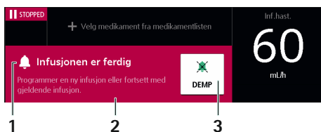
Figur 2: Betjene et alarmskjerm bilde 1. Alarmtittel, 2. Instruksjoner for å korrigere årsaken til alarmen, 3. Pause alarmlyder / minimere alarmvinduet.
