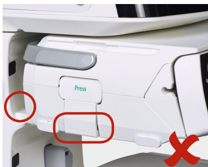
Figure 6: Pumpe satt inn riktig (øverst) og feil (nederst).
